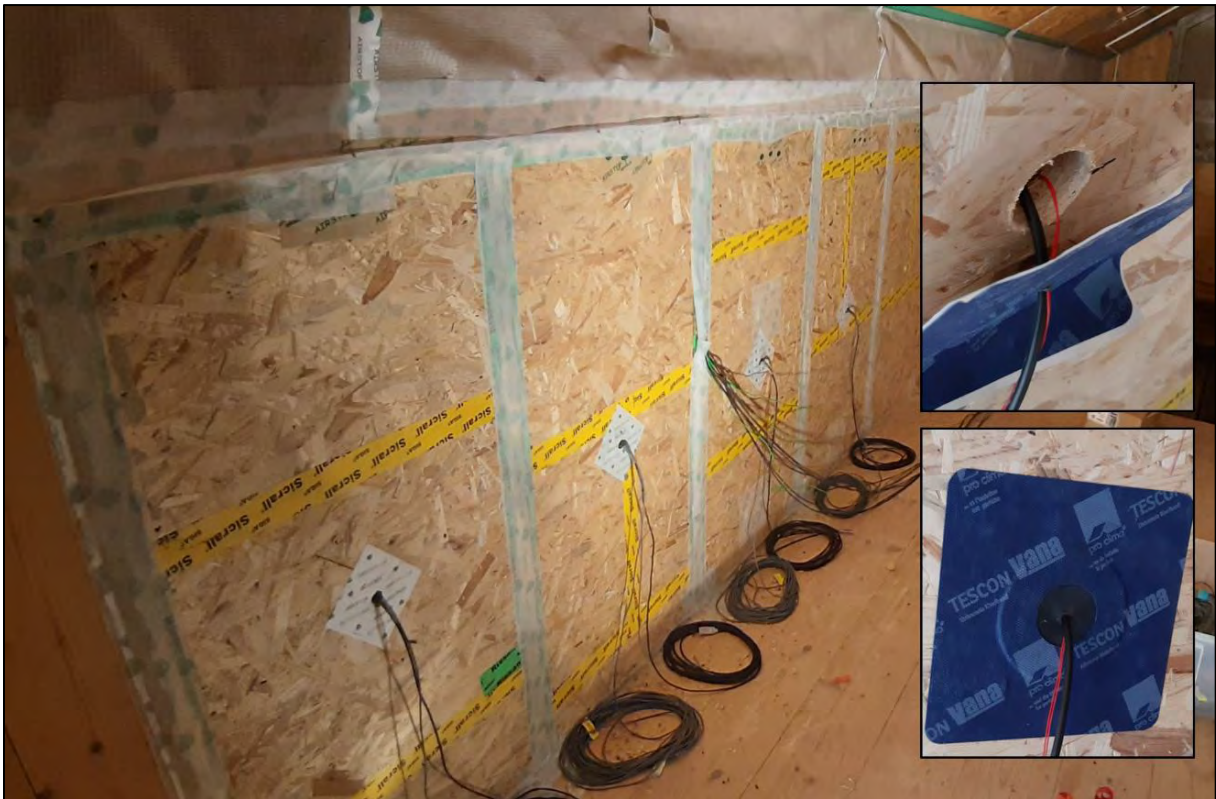
Abbildung 16: Frontaler Einbau der Kombifühler (Messposition „a“).
