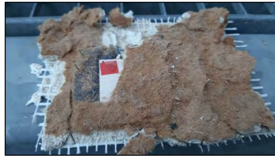
Abbildung 50: Entfernte Putzschicht der Variante N 2.8 (heller Putz) mit Balsasensor- und Holzfaserrückständen. Optisch ist kein Pilzmyzel erkennbar.
