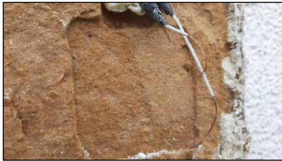
Abbildung 49: Geöffnete Messposition P an der Variante N 2.8 (heller Putz) nach dem Messzeitraum. Optisch ist kein Pilzmyzel erkennbar.
