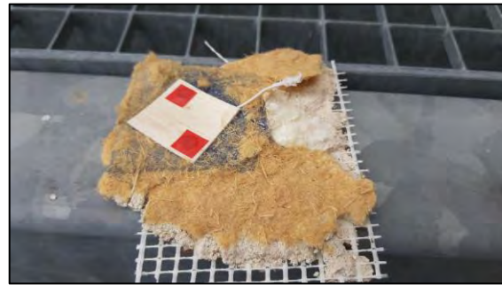
Abbildung 45: Entfernte Putzschicht der Variante N 2.6 (dunkler Putz) mit Balsasensor- und Holzfaserrückständen. Optisch ist kein Pilzmyzel erkennbar.
