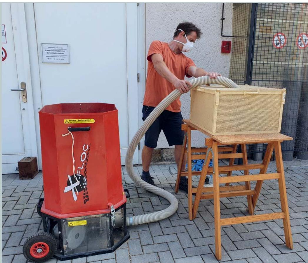
Abb. 2: Verarbeitungsversuch mit Einblasmachine
