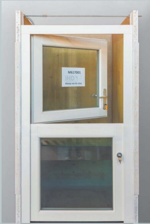
Abb. 1: 2-flügelige Mustertür im Hochwasserprüfstand Fig. 1: : Two-leaf door sample in the flooding test stand
