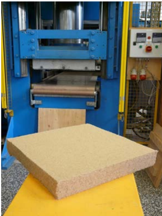
Abb.1.: Holzfaserdämmplatte aus chemisch modifizierten Fasern
