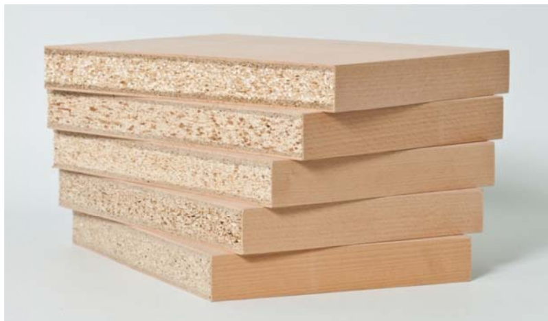
Abb. 2.: Beschichtete Spanplattenmuster mit Spanmischung aus Schneid- und Schlagspänen, Dichte 480 kg/m³, mit Polystyrol (oben), Kork (2. von oben), ohne Füllstoff (Mitte) im Vergleich mit Spanplatte aus Industrie-Mittelschichtspänen ohne Füllstoff mit Plattenrohichte 480 kg/m³ (2. von unten) und 600 kg/m³ (unten); Foto: IHD)
