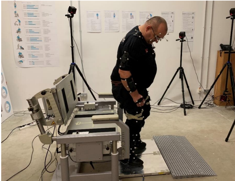
Abbildung 1: Probandenversuch mit Messstuhl und Motion Capture zum Erfassen der Bewegungen
