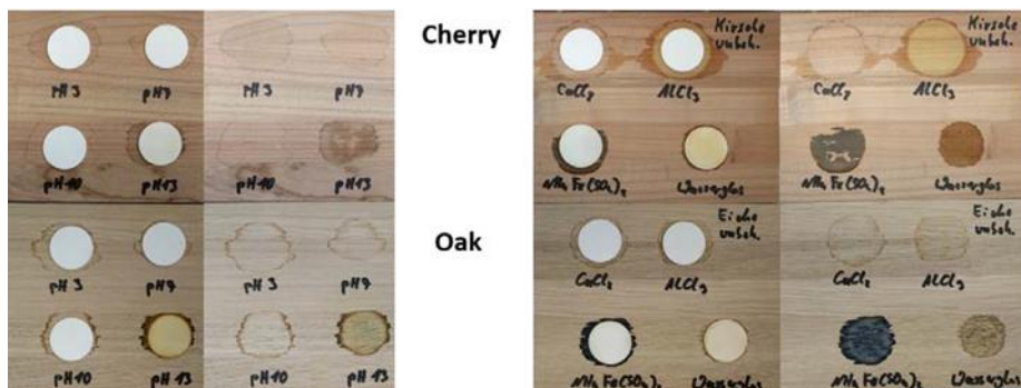
Abbildung 8: Verfärbungen an unbehandeltem Holz
