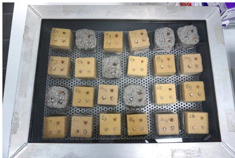
Abbildung 7: Inkubationseinheit mit beimpften Probekörpern. Unter dem Gitter befindet sich die mit Salzlösung bzw. destilliertem Wasser gefüllte Schale.
