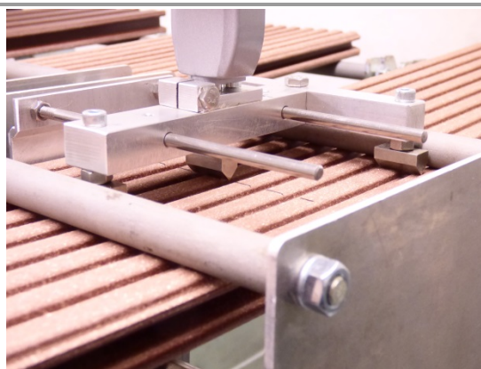
Abbildung 2: Darstellung von schneidenförmigen Füßen an einer Messbrücke zur Bestimmung der Durchbiegung an einer rauhen, unebenen und profilierten WPC-Diele
